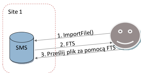
Rysunek 2.1: Schemat działania usługi SMS na przykładzie operacji ImportFile
